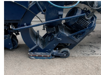
Untergrundvorbereitung z. B. Kugelstrahlen
